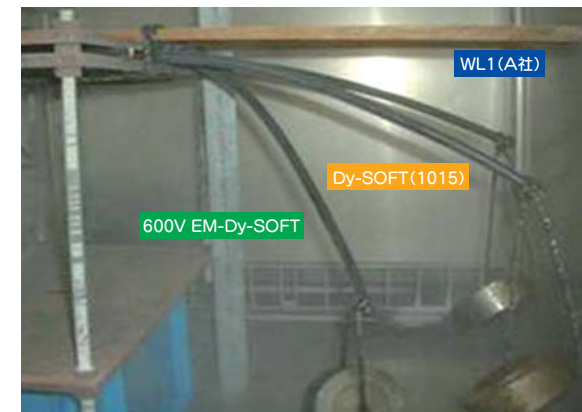
22mm柔軟性他社比較試験結果(-40℃、重り1kg)
